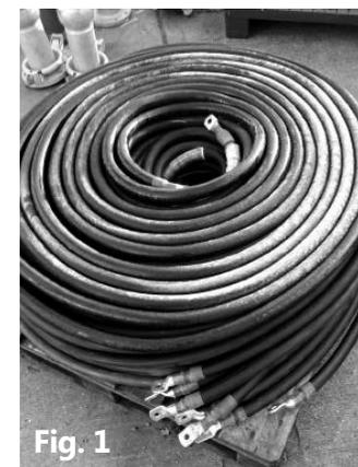
Le point d'entrée du câble est positionné à côté du panneau de commande principal. Câbles de 4 x 120 mm<sup>2</sup> sont requis pour les connexions au panneau électrique principale.
